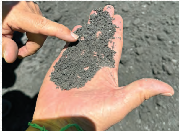
Relaves secos y filtrados, Cozamin
